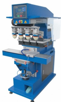
Sistema de tinteiro fechado com retiro e monatgem rápida
