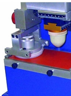
Sistema de tinteiro fechado com retiro e monatgem rápida
