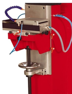
Mesa de impressão ajustável em altura através de volante; micro ajuste em eixo XX e YY
