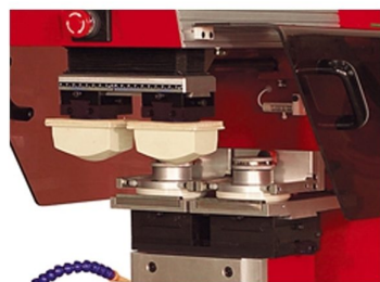
Sistema de impressão através de tinteiro fechado
