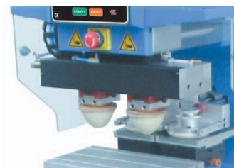
Sistema index de movimento lateral nos tampões para impressão em peças difíceis
