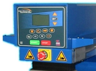
Painel LCD com ajuste electrónico de alturas de impressão e recolha de tinta
