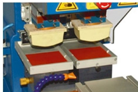
Sistema de impressão feita através de tinteiro aberto a 2 cores
