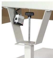
Pode ser equipado com foto célula da leitura da paleta para start automático ou com pedal
