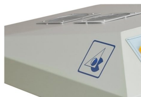
Ventiladores para homogeneização do calor
