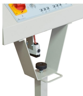
Pode ter opção de foto célula da leitura da paleta, start automático através do comando da maquina ou pedal
