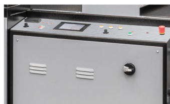
Caixa de IR com 3x lâmpadas com ON/OFF individual para fornecer soque térmico ao material Painel de comando com TOUCH SCREEN 7 polegadas
