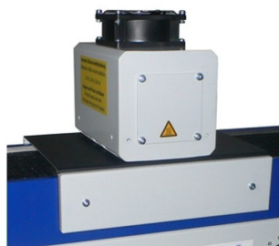
Lâmpada UV sem libertação de Ozono para a atmosfera
