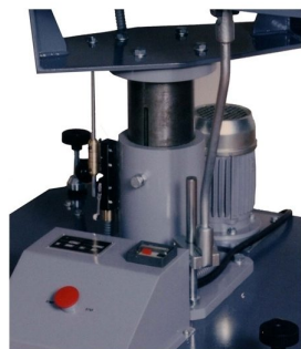
Motor vibratório de alto rendimento c/ botoneira de paragem de emergência
