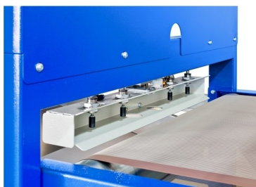
Cilindros de aperto de folha com 4 posições reguláveis
