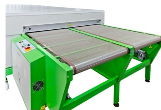
Possibilidade de equipar tunnel com 2 tapetes individuais
