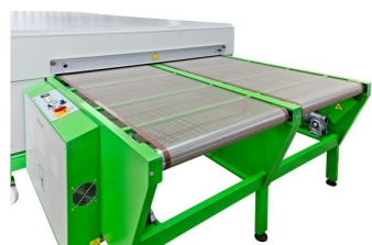
Tuneis com 2 tapetes disponíveis (2º tapete pode ser também de retorno da peça ao operador)
