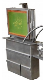
Tanque de imersão de quadro (DIP TANK) com capacidade para 2 quadros em simultâneo
