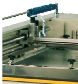
Ângulo de impressão e pressão de racklete e contra racklete individual e ajustável
