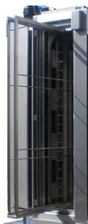
Barra rotativa de aplicação de solvente nos dois lados do quadro
