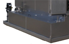
Deposito de solvente para funcionar em circuito fechado
