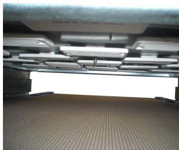
Distribuição perfeita sobre a largura das resistências cerâmicas
