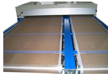
Possibilidade de equipar túnel com 2 tapetes
