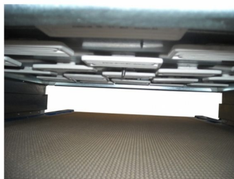
Distribuição perfeita das resistências sobre a largura do tapete
