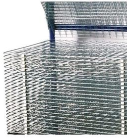
Espaçamento entre grades de 25 mm para colocação de material com espessuras
