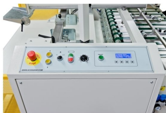
Display com LCD para fácil ajustes de vários temporizadores existentes
