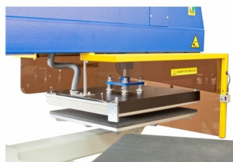
Fotocélulas de segurança nas cabeças de transfer para segurança do operador
