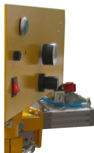
Movimento lateral feito através de cilindro pneumático
