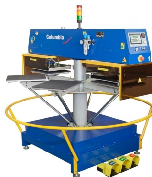
Movimento lateral feito através de cilindro pneumático
