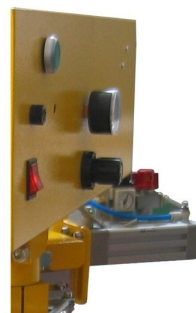
Movimento lateral feito através de cilindro pneumático
