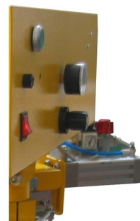
Movimento lateral feito através de cilindro pneumático
