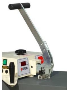
Descida do prato de calor vertical com manípulo de elevada resistencia
