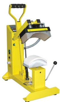
Abertura da prensa lateral para conforto do operador
