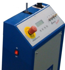
Painel com display LCD com possibilidade de utilizar diversos programas de impressão para diversos tipos de tinta (base de água; plastisol);
