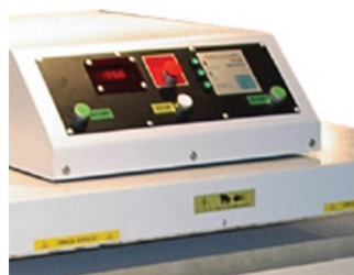
Controlador de temperatura com programa de economização de energia
