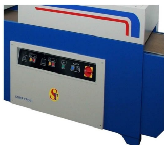
Controlo de temperatura individual feito em cada modulo
