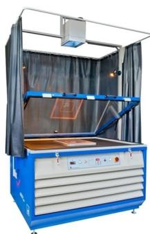
Sistema compactos de exposição e secagem do quadros na máquina
