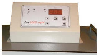
Programador digital com controlo de tempos de exposição e fotocélula de leitura de intensidade de luz e ajuste automático do tempo
