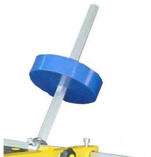
Contra - peso com ajuste de posição para equilíbrio do quadro de impressão
