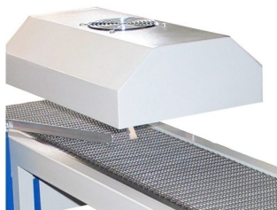
Equipado com campânula com fonte de calor infra vermelhos
