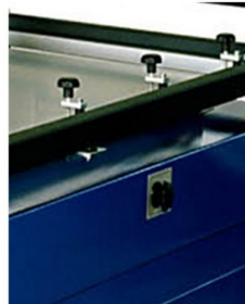
Registos micrométricos de impressão no tampo de vácuo
