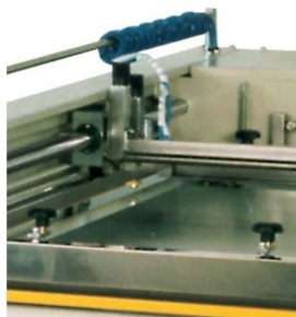
Ângulo de impressão e pressão de racklete e contra racklete individual e ajustável
