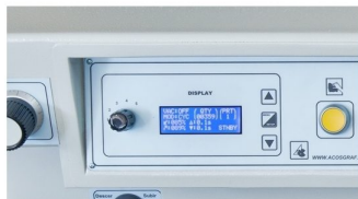
Display com LCD com diversas informações de velocidades, tempos, modos de trabalho, etc..
