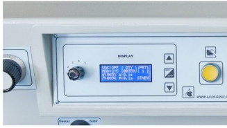
Display com LCD com diversas informações de velocidades, tempos, modos de trabalho, etc..
