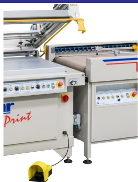
Retirador de folhas pode ser construído lateralmente (esquerda ou direita) ou traseiro
