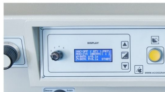
Display com LCD com diversas informações de velocidades, tempos, modos de trabalho, etc..
