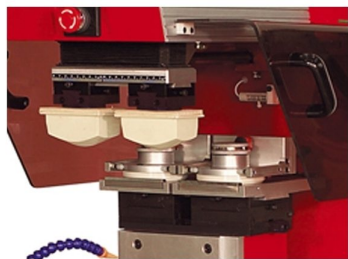
Sistema de impressão através de tinteiro fechado
