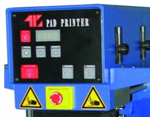
Painel LCD com possibilidades de temporizações independentes
