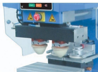
Sistema index de movimento lateral nos tampões para impressão em peças difíceis
