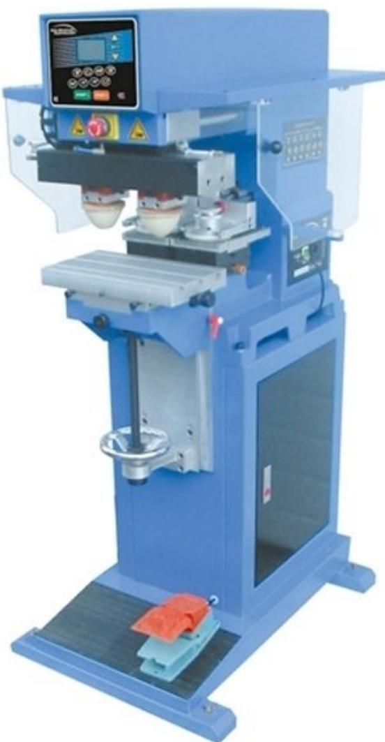
O equipamento TP 127 - INDEX é uma maquina de tampografia pneumática a 2 cores que utiliza tinteiro fechado. A máquina TP 127 - INDEX pode ser equipada com opção a descida de tampões diferenciada e limpeza automática de tampão.
