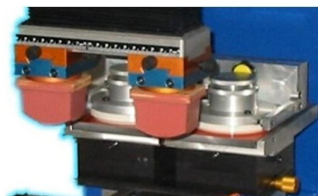
Sistema de impressão feito através de tinteiro fechado com possibilidade de impressão a 2 cores
