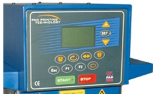
Painel LCD com ajuste electrónico de alturas de impressão e recolha de tinta
