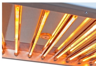
Sensor de leitura da temperatura instantanea no material a secar
