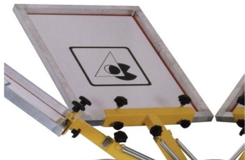
Pinça traseira, precisa e segura de fixação dos quadros
