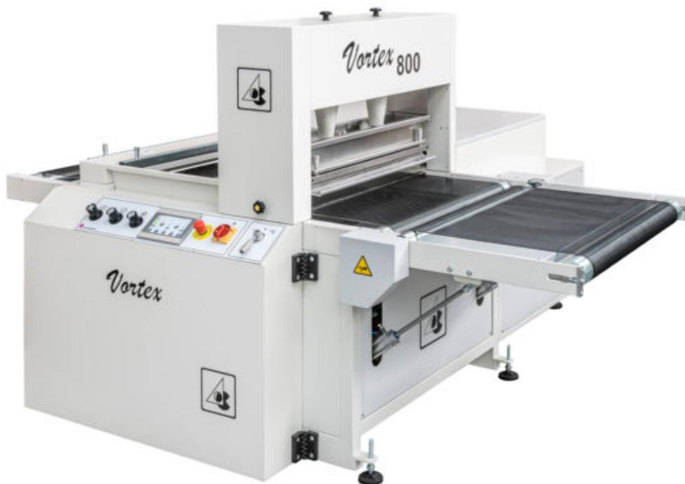
O VORTEX + CROSS OVER é uma máquina automática de aplicação de pó de transfer utilizado na indústria de serigrafia na produção de transferes . O VORTEX + CROSS OVER aplica automaticamente o pó de transfer na folha que depois através de um sistema de sopro/aspiração removendo o pó excedente sem contaminação do local de trabalho. O VORTEX + CROSS OVER utiliza o pó de transfer num sistema de circuito fechado fazendo assim a economização do pó excedente.
