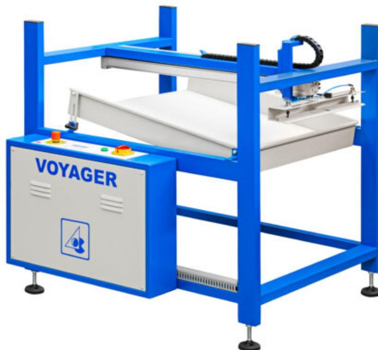
O VOYAGER é um stacker automático de empilhação de folhas que faz automaticamente a recolha da folha à saída do tunel utilizando um pinça pneumática. O stacker VOYAGER está disponível em diversos modelos e pode ser utilizado individualmente ou integrado em linhas de impressão. O VOYAGER pode ser equipado com uma ou duas pinças individuais de retiro de peça.
