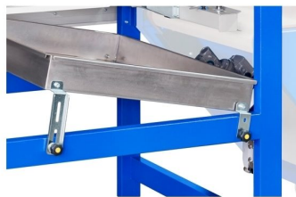
Mesa de recepção de folha com ajustes de inclinação e altura
